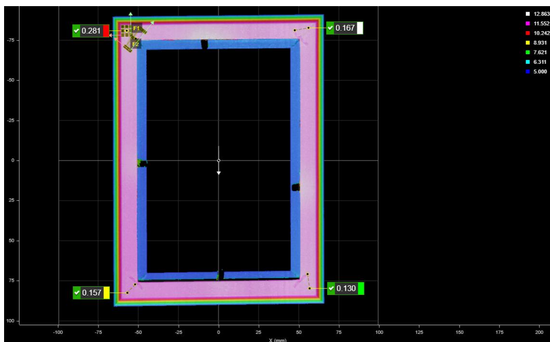
Rysunek 4 Sprawdzanie poprawności montażu i geometrii obiektów – w tym przypadku głębokość i poprawność wbicia elementów łączących ściany
