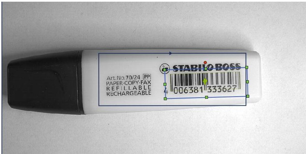
Rysunek 3 Odczyt kodów kreskowych – odczyt kodów 1D i 2D, klasyfikatory zgodne z ISO 15415 i ISO 15416
